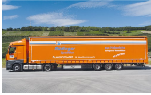
Megasattel Nutzlast: 25.000 kg, Verbreiterung: bis 4,10 m
