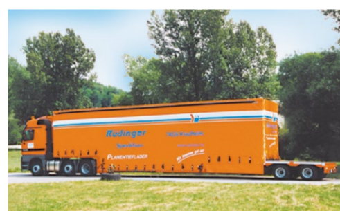
Teletiefbettsattel Nutzlast: 20.000 - 24.000 kg, Verbreiterung: bis 5,00 m Teleskopierbar um 3 m → 16,60 m Gesamtlänge
