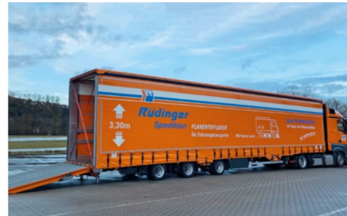
Klappensattel als 15 m Auflieger Nutzlast: 24.000 kg, Verbreiterung: bis 5,00 m
