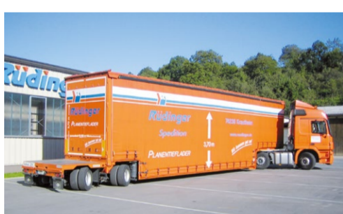
Einachs-Tiefbettsattel schwer Nutzlast: 18.000 kg, Verbreiterung: bis 6,00 m
