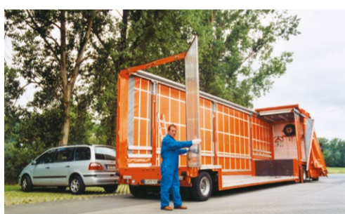
Einachs-Tiefbettsattel leicht Nutzlast: 12.000 kg, Verbreiterung: bis 6,00 m
