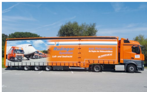
Schwanenhalsattel Nutzlast: 22.500 - 32.000 kg, Verbreiterung: bis 4,50 m
