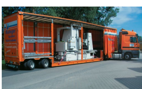
Zweiachs-Tiefbett Nutzlast: 22.000 - 33.000 kg mit Andockachse, Verbreiterung: bis 6,00 m
