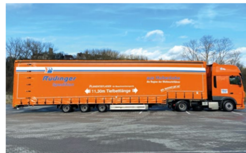
Schwanenhalsattel als 15 m Auflieger Nutzlast: 24.000 - 26.000 kg, Verbreiterung: bis 4,50 m
