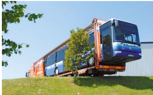
Schrägsattel starke Keilform Nutzlast: 24.000 kg, Verbreiterung: bis 5,00 m
