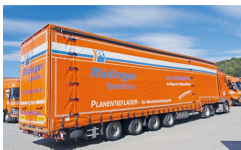
Schwanenhals 4-Achs, Schwerlast Nutzlast: 21.000 - 40.000 kg, Verbreiterung: bis 4,50 m
