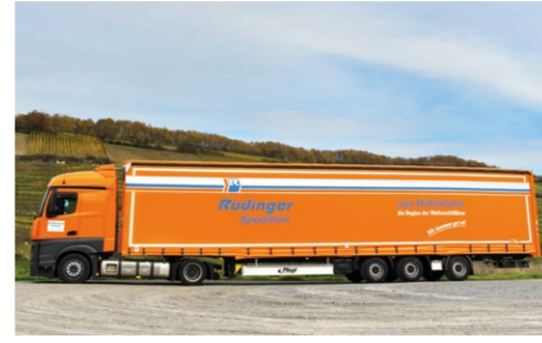
Megasattel als 15 m Auflieger Nutzlast: 25.000 kg, Verbreiterung: bis 4,50 m
