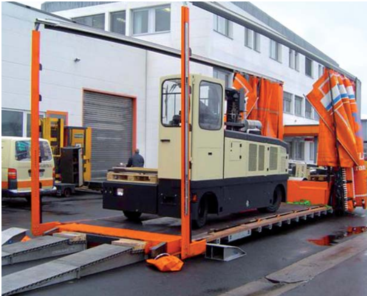
Abgetrennter Auflieger, direkt befahrbar
